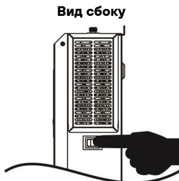
После правильной установки устройства и надежного подключения аккумуляторных батарей просто нажмите кнопку включения/выключения (на боковой панели), чтобы включить устройство.
